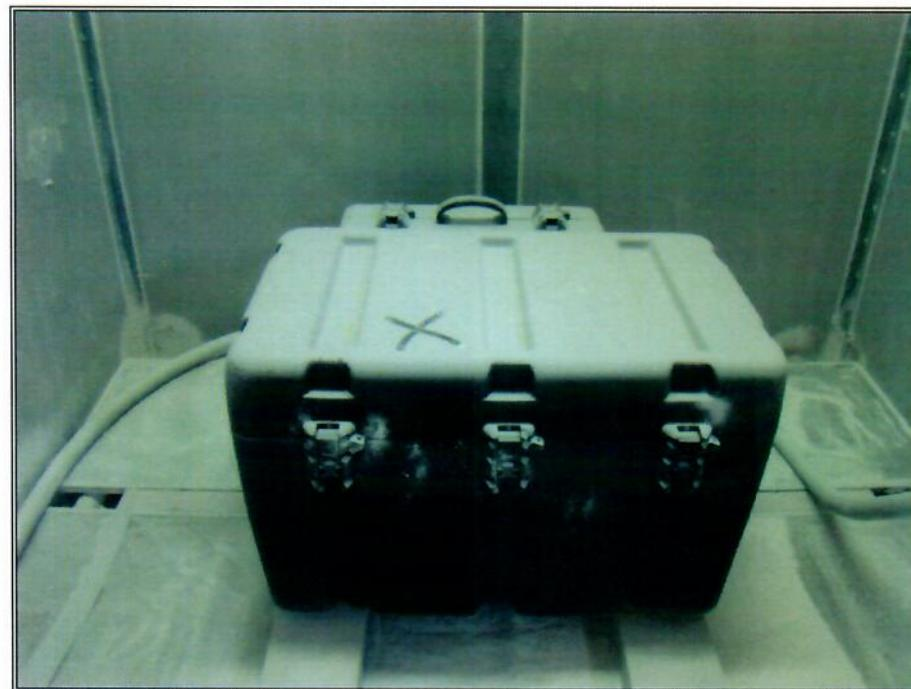
**Figura 64 – Mala (Case) após exposição na câmara de poeira**
