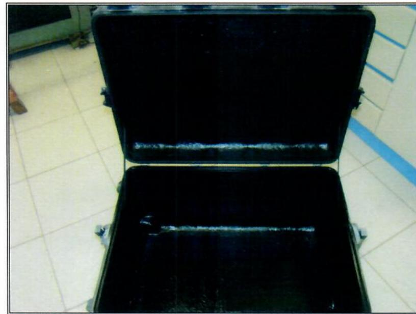
**Figura 70 – Interior da mala (Case)**
