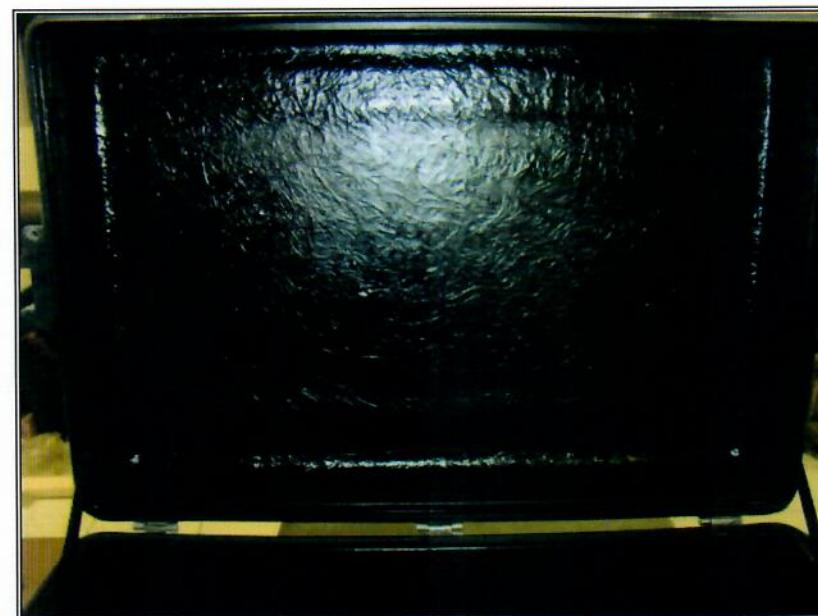
**Figura 74 – Interior da tampa após exposição na câmara de poeira
