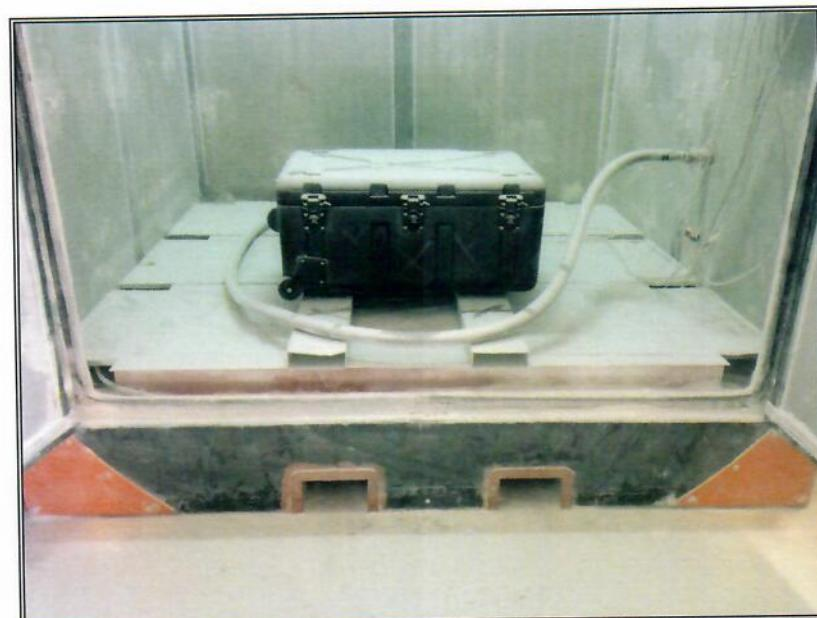
**Figura 54 – Mala (Case) após exposição na câmara de poeira**
