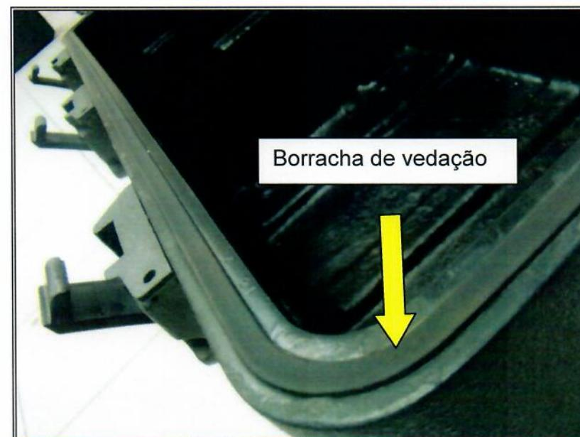
Figura 24 - Junta de vedação e cavidade para assentamento da junta de vedação
