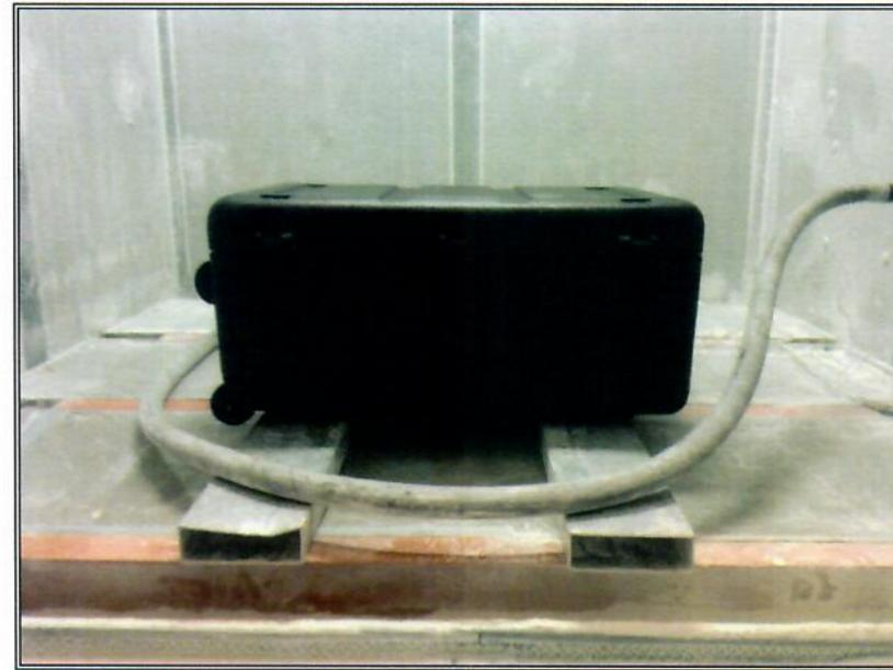
**Figura 53 – Mala (Case) no interior da câmara de poeira antes do ensaio**
