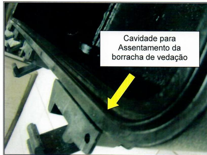
**Figura 39 - Cavidade para assentamento da borracha de vedação na tampa**
