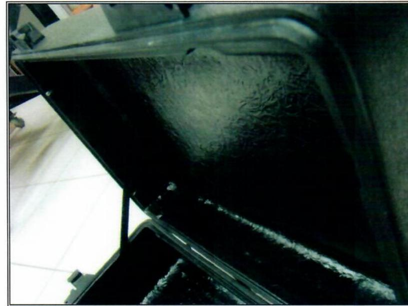
**Figura 52 – Parte interna da tampa e detalhe da vedação de borracha**
