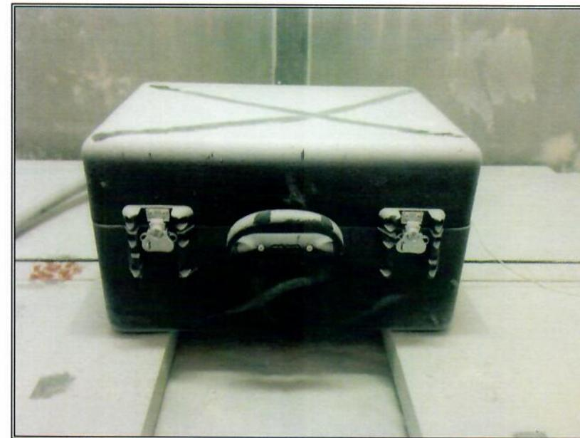
**Figura 60 – Mala (Case) após exposição na câmara de poeira**
