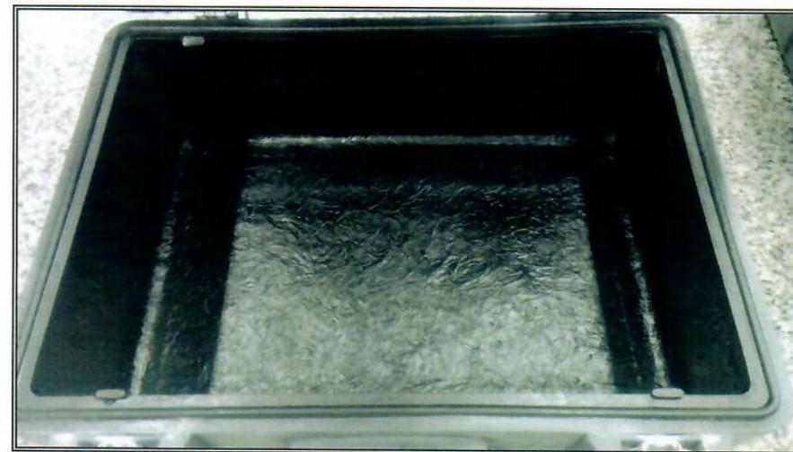
**Figura 61 – Interior da mala (Case) após exposição na câmara de poeira****(Inexistência de poeira)**
