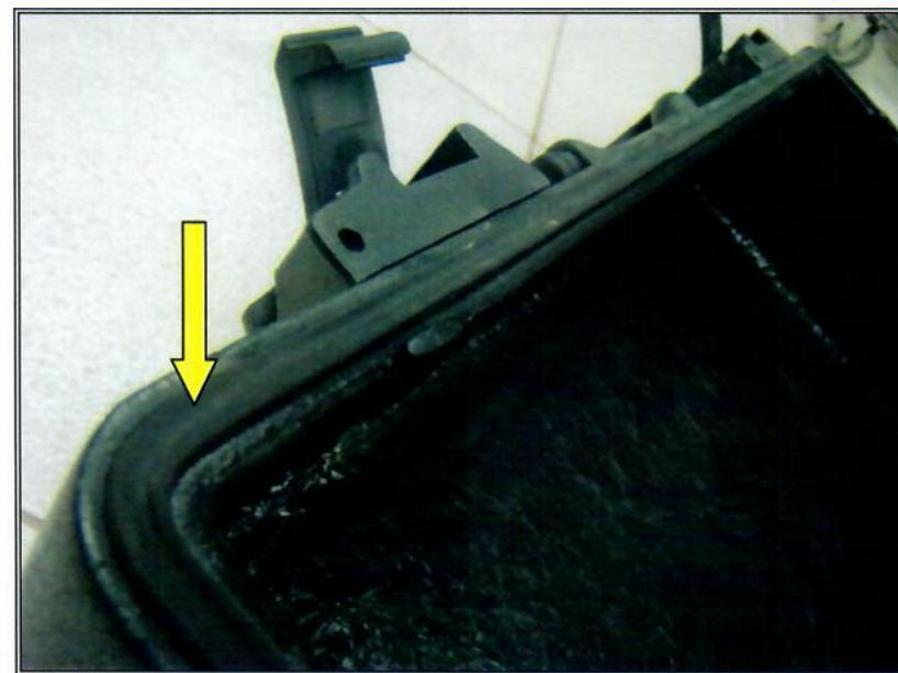
**Figura 51 - Detalhe do perfil da borracha de vedação**
